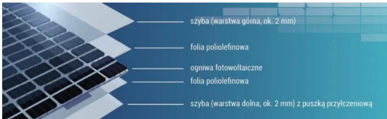
Rysunek 10 Przekrój modułu PV bifacjalnego
