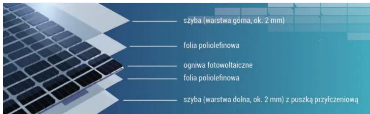
Rysunek 10 Powyższe foto przedstawia przekrój modułu PV bifacjalnego
